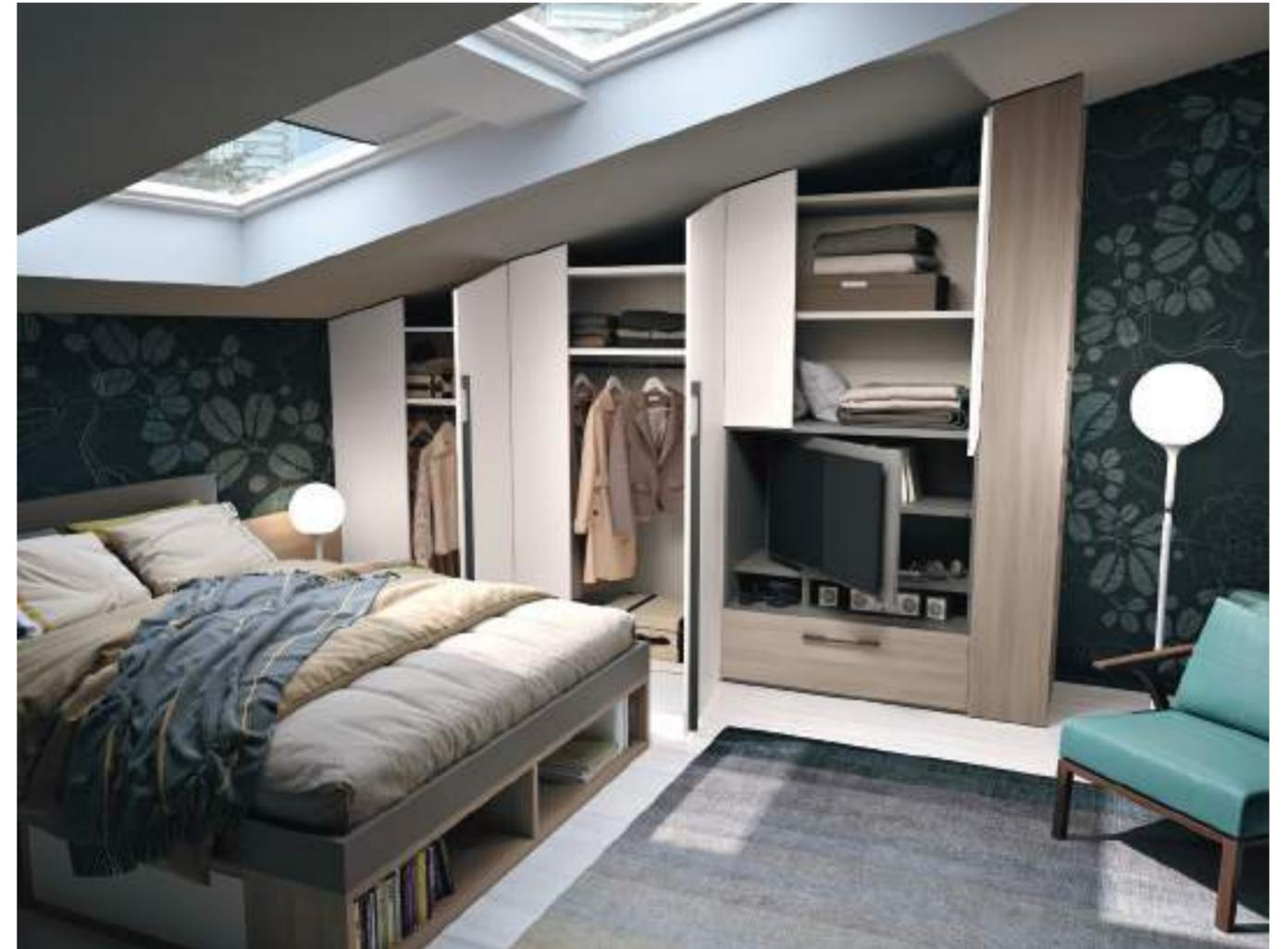
**L'immagine dell'armadio aperto ci permette vedere le aperture dei tre moduli L 105 cm. Il primo ha l'anta fissa da 45 l'anta da 60 con cerniere 165°. Gli altri 2 moduli hanno l'anta fissa da 30 e l'altra da 75.**
